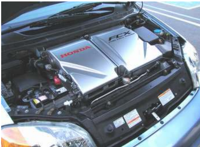
Här visas bränslecellsstacken i en Honda FCX. Den driver en elmotor på 60 kW som ger hela 272 Nm från start.
