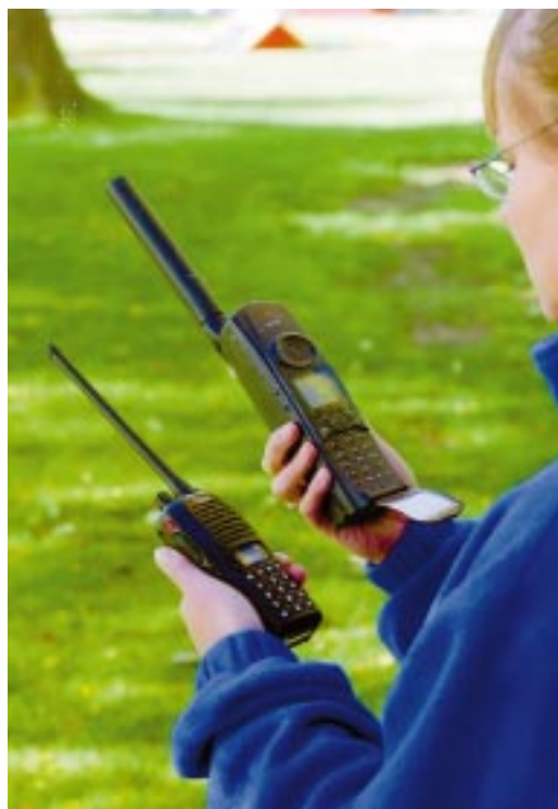
Markbundet och/eller satellit? Det finns olika utvecklingsvägar för att förbättra kommunikationerna i fjällen. Den vänstra telefonen är en radiotelefon och den högra en satellittelefon.
